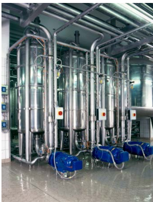
Bild 11-12: Prozesstanks aus Edelstahl Rostfrei mit Qualitätssiegel sind für eine perfekte Gärung und Lagerung unverzichtbar.
