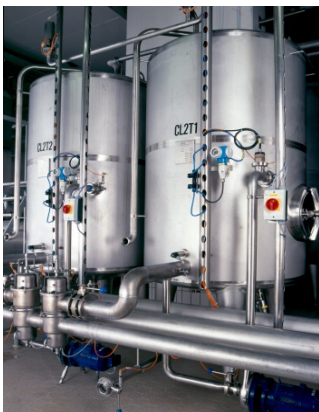
Bild 11-12: Prozesstanks aus Edelstahl Rostfrei mit Qualitätssiegel sind für eine perfekte Gärung und Lagerung unverzichtbar.
