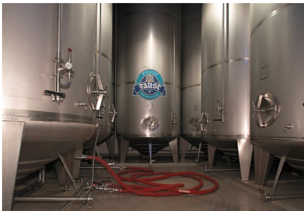
Bild 7: In Edelstahl-Gärtanks erfolgt bei exakt gesteuerter Kühlung die Umwandlung des Zuckers in Alkohol und Kohlensäure.
