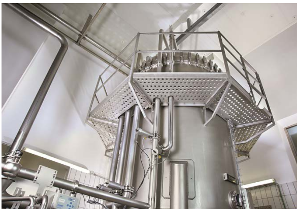
Bild 8: Nach der Reifung werden letzten noch im Bier enthaltenen Trübstoffe mit einem Kerzenfilter aus rostfreiem Edelstahl herausgefiltert.
