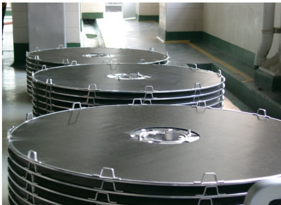
Bild 9: Auf großen Tellerfiltern aus Edelstahlgewebe werden nach Abschluss des Garprozesses im Bier noch enthaltene Trübstoffe abgefiltert.
