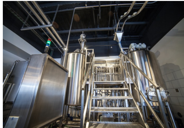
Bild 4: Mikrobrauereien kommen bei der Bierherstellung mit nur zwei bis sechs Edelstahlgefäßen für alle Prozessschritte aus.
