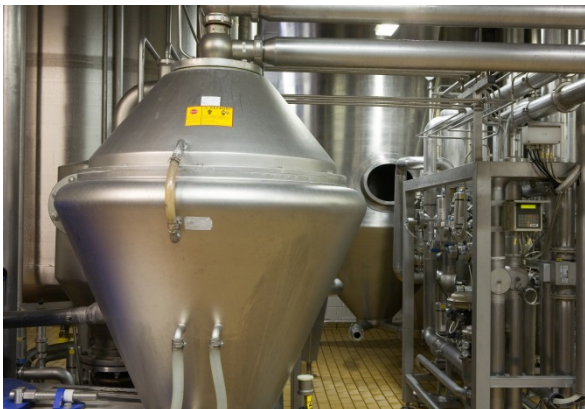
Bild 6: Trübstoffe setzen sich durch Rotation in der Zentrifuge aus nichtrostendem Stahl ab.
