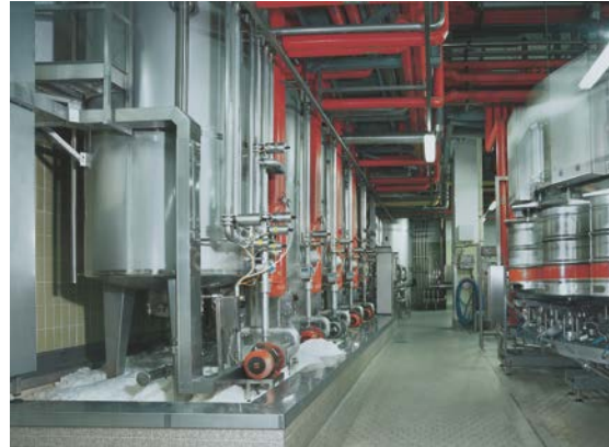
Bild 13-14: CIP (Cleaning-in-Place)-Tanks aus Edelstahl sorgen dafür, dass Hygiene auch in Brauereien das A und O ist.
