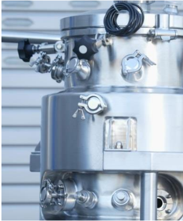
Bild 1: Prozessbehälter aus Edelstahl Rostfrei gewährleisten innen wie außen dauerhafte Korrosionsbeständigkeit.
