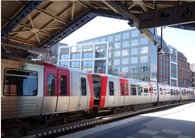
Bild 5: Festigkeit bei geringer Materialdicke machen Edelstahl Rostfrei zum Werkstoff der Wahl im Waggonbau.
