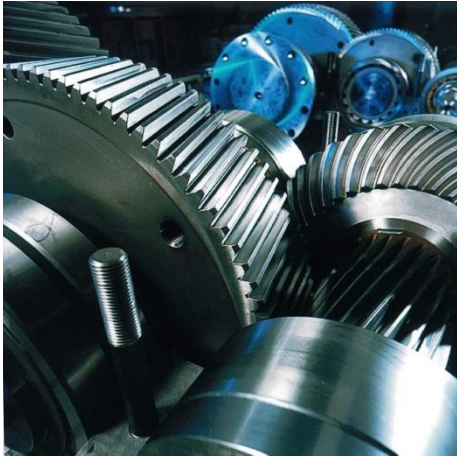
Bild 9: Getriebe aus Edelstahl Rostfrei halten den enormen Drücken in Wasserkraftwerken zuverlässig stand.
