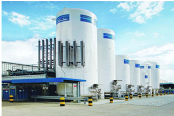
Bild 7: Die komplett aus entmagnetisiertem Edelstahl Rostfrei gefertigten Kryobehälter haben ein Fassungsvermögen von bis zu 41.000 Litern.
