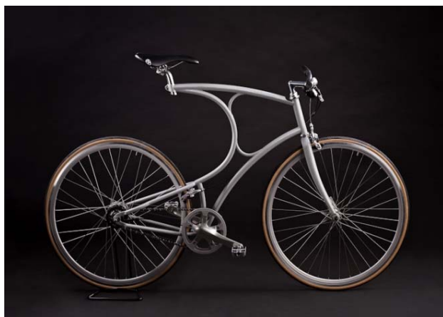
Bild 3: Extrem leichte Rahmen aus Edelstahl Rostfrei mit Qualitätssiegel bieten Rennrädern Gewichtsvorteile und Fahrdynamik.
