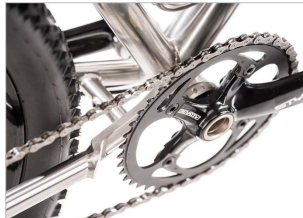
Bild 8: Ketten aus nichtrostendem Stahl gewährleisten dank Korrosionsbeständigkeit die geforderte Langlebigkeit.
