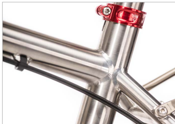
Bild 4: Mit speziell geformten Rohren aus nichtrostendem Stahl lässt sich das Verhältnis von Gewicht und Steifigkeit zusätzlich optimieren.
