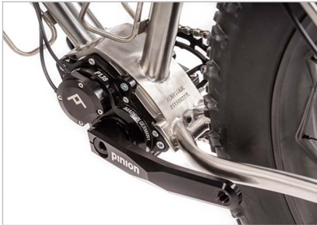
Bild 5: Gefertigt aus Edelstahl Rostfrei mit Qualitätssiegel hält die Getriebschaltung selbst extremen Bedingungen stand.
