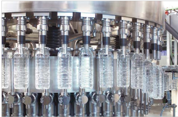
Bild 1: Edelstahl Rostfrei mit Qualitätssiegel sichert lange Laufzeiten und höchste Sauberkeit in der Wasserabfüllanlage.
