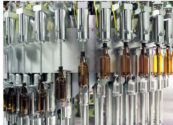
Bild 2: Bakteriologisch unbedenklich und leicht zu reinigen: Abfüllanlagen aus Edelstahl Rostfrei schonen das Produkt.
