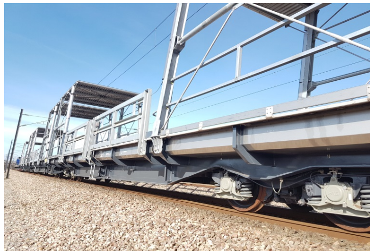
Bilder 7+8: Seitenansicht eines Transportwaggons der Eurotunnel-Freight-Shuttles mit zwei Pagoden aus Edelstahl Rostfrei.
