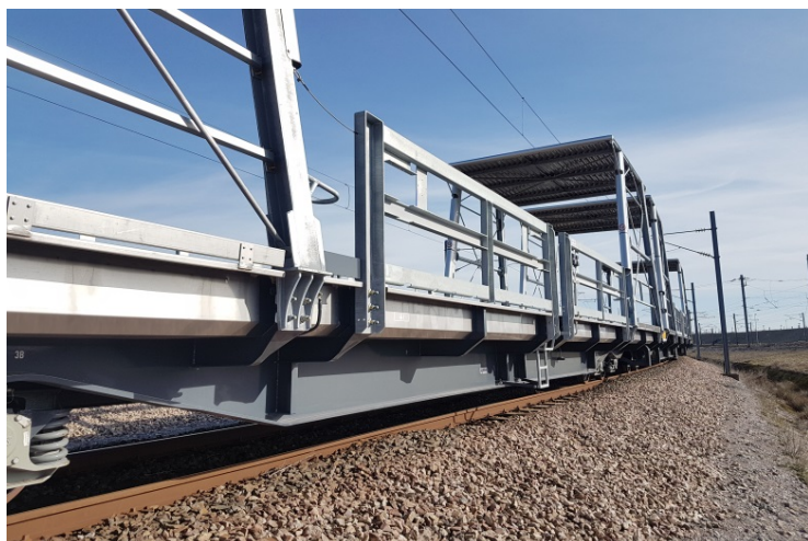
Bilder 7+8: Seitenansicht eines Transportwaggons der Eurotunnel-Freight-Shuttles mit zwei Pagoden aus Edelstahl Rostfrei.
