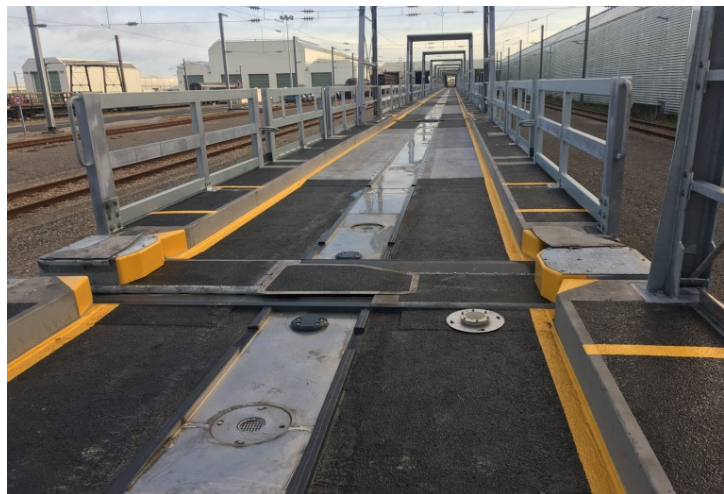
Bild 10: Der Blick auf die Ladefläche eines Transportwaggon des Eurotunnel-Freight-Shuttles zeigt in der Mitte den Drainagekanal mit Abflüssen zum Drainagetank aus Edelstahl Rostfrei.
