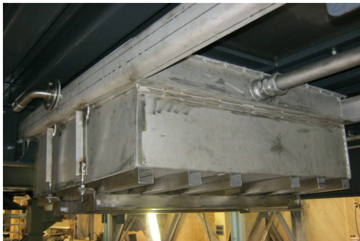
Bild 11: Unter dem Transportwaggon des Eurotunnel-Freight-Shuttles befinden sich der Drainagetank und die Rohre aus Edelstahl Rostfrei, über die Schmutzwasser und andere Flüssigkeiten der LKW abgeleitet werden.
