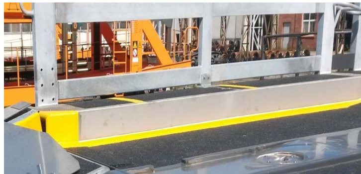
Bild 6: Über den Seitengang aus 2,5 mm dickem Edelstahl Rostfrei an der Ladefläche der Transportwaggons gelangen die Fahrer von und zu ihren LKW. Er bildet zugleich durch seinen Absatz die Fahrspurbegrenzung für die LKW.
