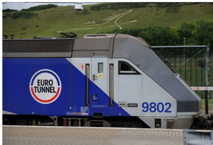
Bild 4: An Kopf und Ende aller Reisezüge befindet sich jeweils eine Lokomotive, sodass beim Ausfall einer Lokomotive sofort die andere zum Einsatz kommen kann.
