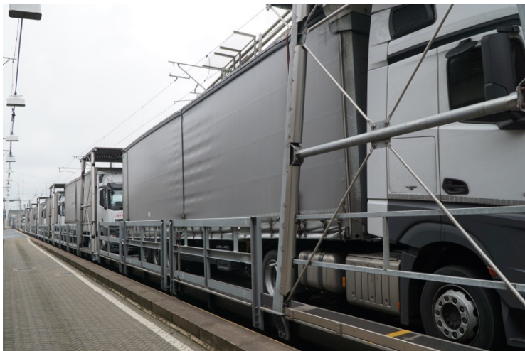
Bild 9: Bis zu 32 LKW werden auf die pritschenwagen-ähnlichen Waggon der Eurotunnel-Freight-Shuttles verladen.
