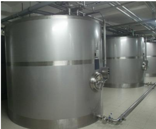
Bild 5-7: Gewährleisten innen wie außen dauerhafte Korrosionsbeständigkeit: Prozessbehälter aus Edelstahl Rostfrei
