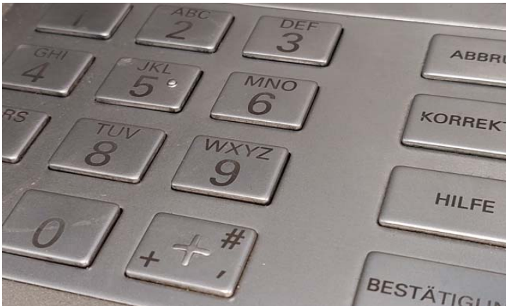
Bild 3: Unverzichtbar für selbstständiges Bedienen durch blinde Menschen sind tastbare Orientierungshilfen auf den Edelstahltastaturen von Bankautomaten, Verkaufs- oder Ticketterminals.
