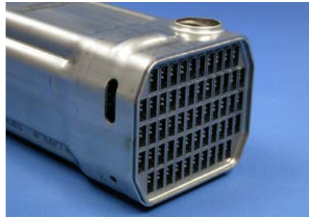
Bild 2: Edelstahlrohre im Abgaskühler erzeugen einen turbulenten Gasdurchfluss.
