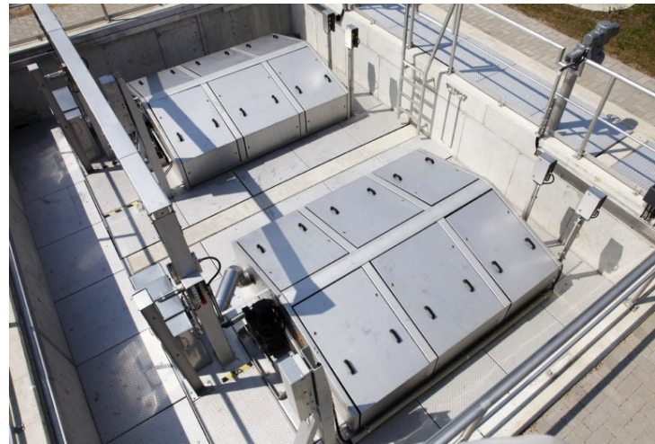
Bild 2: Scheibenfilter aus Edelstahl Rostfrei ermöglichen auf großer Filterfläche das Abscheiden feinsten Feststoffe aus Abwässern.
