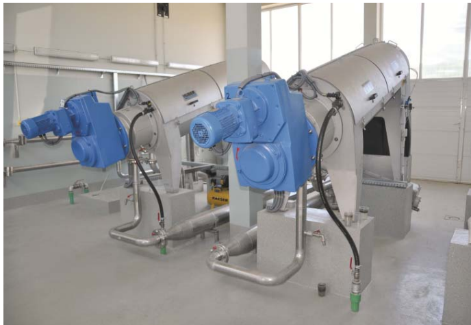
Bild 7: Niedrige Betriebskosten und hohe Entwässerungsleistung sprechen für den Einsatz von Schneckenpressen aus nichtrostendem Edelstahl.
