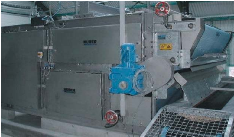
Bild 5: Siebbandpressen entwässern durch die Kombination von Bogenzone, Filterwalzen und Presswalzen den Schlamm.
