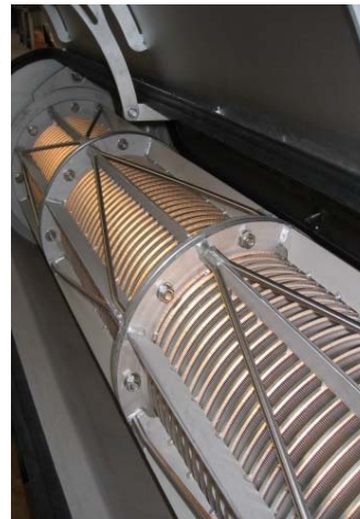
Bild 8: Nach der Einlaufzone wird der Schlamm durch eine konische Schneckenwelle, die den Schlammkuchen nach außen gegen ein Edelstahl-Spaltsieb drückt, entwässert.
