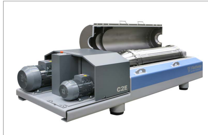
Bild 6: Mit einer Trommel aus Duplexstahl gewährleisten Dekanterzentrifugen trotz hoher Drehmomente an der Schnecke lange Standzeiten und optimale Abscheidemengen.
