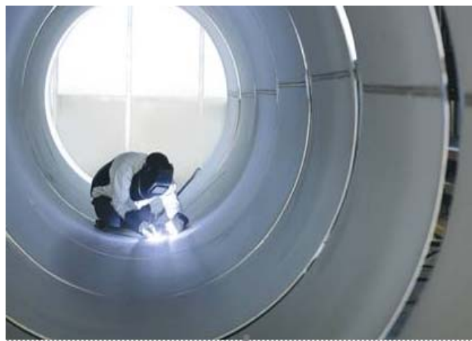
Bild 4: Komponenten aus Edelstahl Rostfrei verhindern schleichenden Gasaustritt und schützen die Bauteile durch gleichbleibend hohe Festigkeit, Duktilität und Homogenität vor Versprödung.
