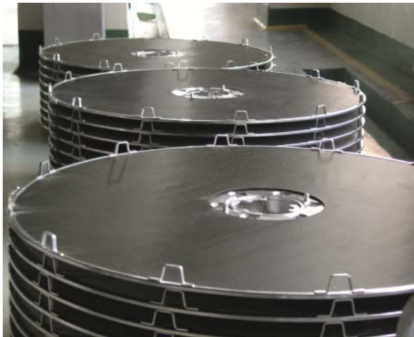
Bild 18: Filterscheiben aus Edelstahl-Gewebe sind Elementen aus Kunststoffgewebe deutlich überlegen.
