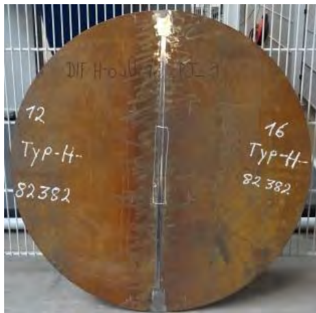
Bild 7: In einem bi-axialen Fallversuch wurden stumpfnahgeschweißte Proben aus DIFENDER Sicherheitsstahl untersucht.
