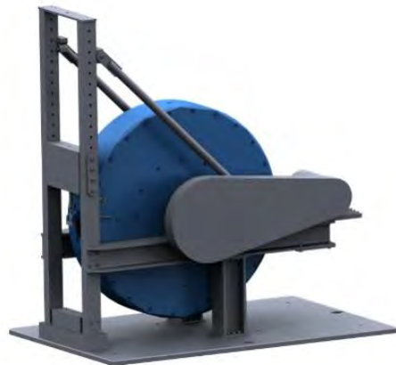
Bild 3: Aufbau eines hochdynamischen Zugversuchs mit einer Dehnrates von 5m/s zur Simulation einer Beschussbeanspruchung an DIFENDER Schweißproben..
