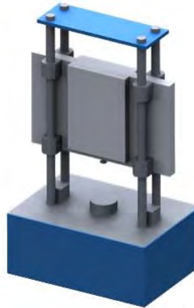
Bild 6: Aufbau eines bi-axialen Fallversuchs mit einer 5,5 t Last zur Simulation der Blastbeanspruchung an stumpfnahgeschweißten Proben aus DIFENDER Sicherheitsstählen
